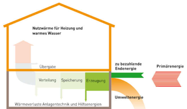
Energiefluss einer Wärmepumpenheizung nach EnEV; Quelle: HEA
