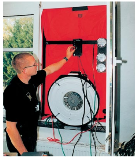
Blower-Door-Test: Schemazeichnung (Bild oben). Einfache Durchführung der Dichtheitsprüfung für das Gebäude durch eine Fensteröffnung (Bild unten).
